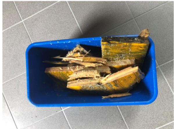
Fotos Vorfall vom 22.6.2020: Wirkungsgradeinbusse durch Schalttafeln in der Turbineneinlaufspirale
